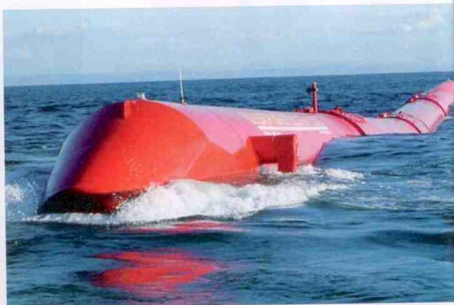
Pelamis-Konverter wandeln die Bewegung der Wellen in Strom um. Mehrere Anlagen können zu einer Wellenenergiefarm zusammengeschlossen werden.
